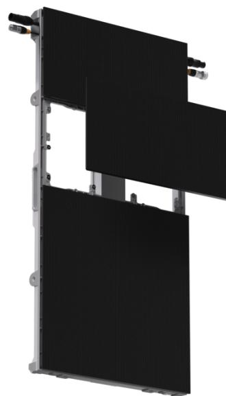
Schritt 3: Mit einem Schraubenschlüssel können dann die Schrauben von der Backbox gelöst werden um an die Receivingcard, das Hubboard und das Netzteil ranzukommen.
